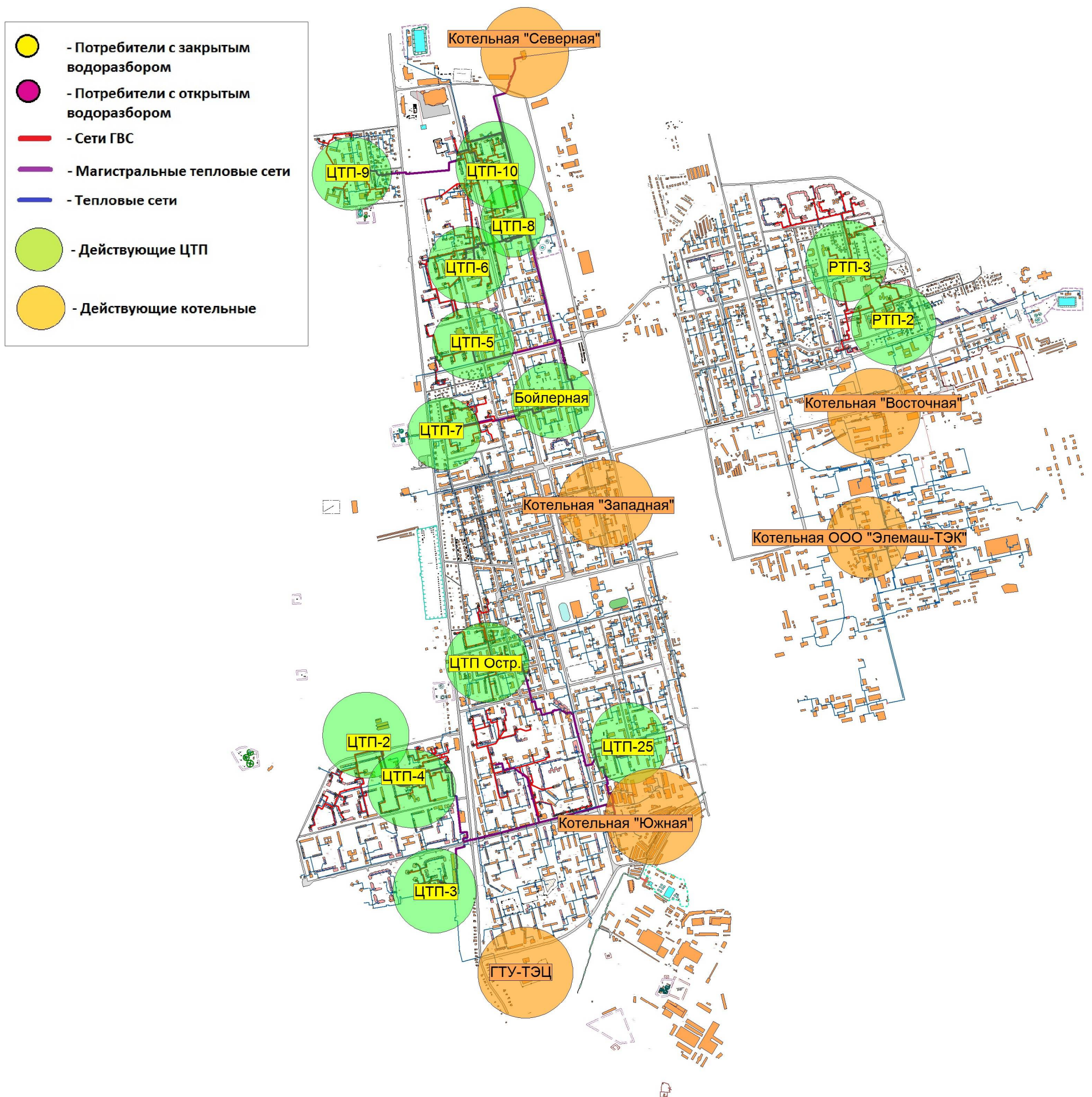
Рисунок 4.5 - Карты (схемы) существующего размещения сетей централизованных систем горячего водоснабжения ГО Электросталь
