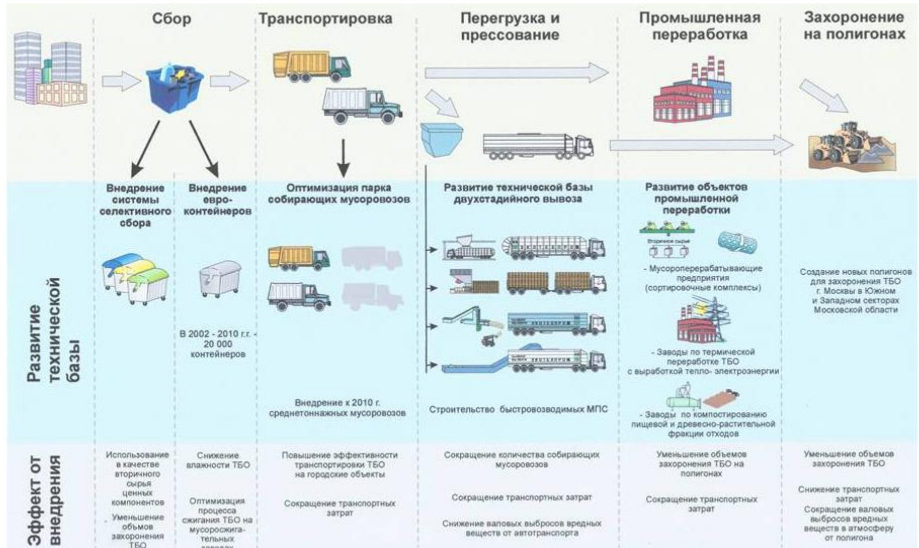
Рисунок 26. Комбинированная схема переработки ТКО.
