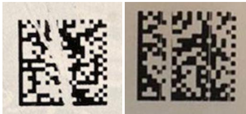
Нарушение целостности КМ*
