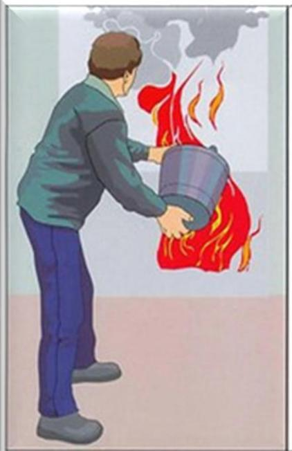
Тушение пожара членами внештатного пожарного расчёта с применением внутреннего противопожарного водопровода осуществляется только после отключения электрооборудования.
