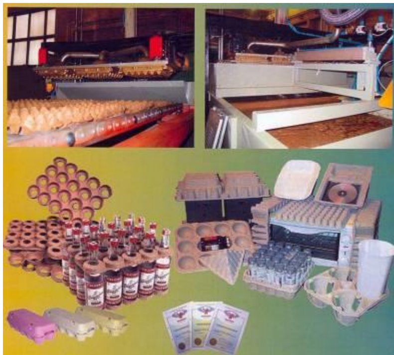
Рисунок 14. Технологическая линия для изготовления тары и упаковки из макулатуры.
