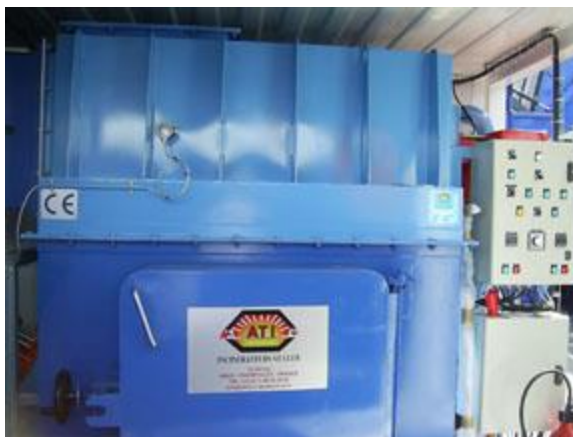
Рисунок 30. Установка «Мюллер» С.Р. 50 (50 кг/час), смонтированная в 20-футовом контейнере
